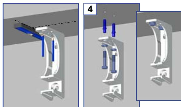
Fixation avec des vis Ø12mm. Kit de vis, cheville et rondelle non fournis.
