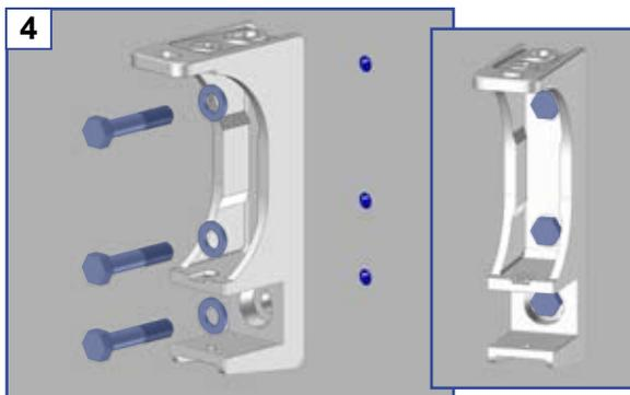
Fixation avec des vis Ø12mm. Kit de vis, cheville et rondelle non fournis.
